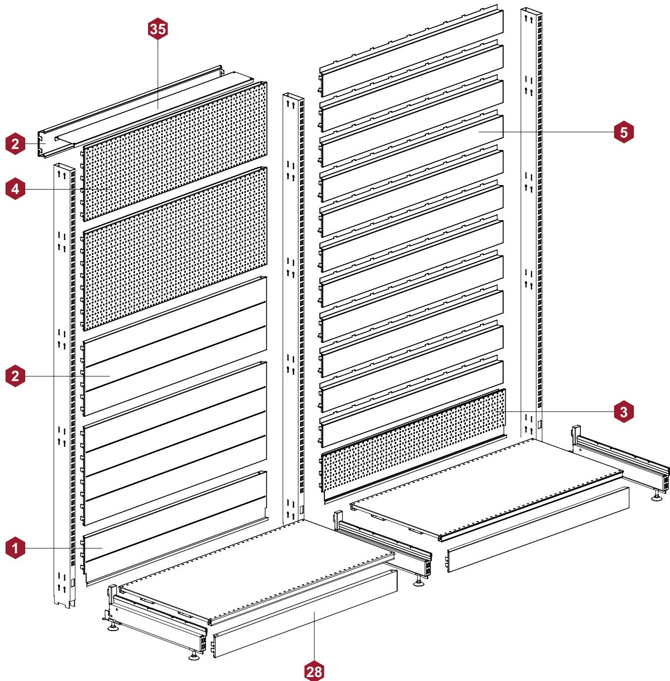
СТЕНКИ ЗАДНИЕ СТЕЛЯННЫЕ, СТЕНКИ ЗАДНИЕ ДСП -
