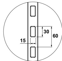
Стенка задняя из штанг 40x20 - Multibar back panel 40x20
